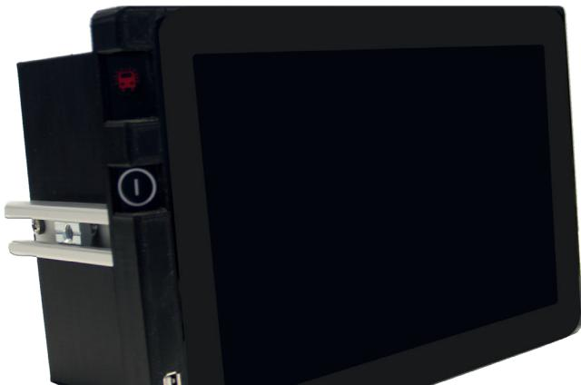
Das Bedienteil MMIIB der Zugfunkfamilie MESA 26 ist für die menügeführte Steuerung des digitalen und analogen Zugfunks vorgesehen. Es erfüllt die Anforderung für den Einsatz auf Schienenfahrzeugen und ist für den Pulteinbau im Führerstand konzipiert. Mit Hilfe einer Sprecheinrichtung, bestehend aus Handapparat und Lautsprecher, ist der Triebfahrzeugführer in der Lage, vielfältige Kommunikationsaufgaben durchzuführen.
