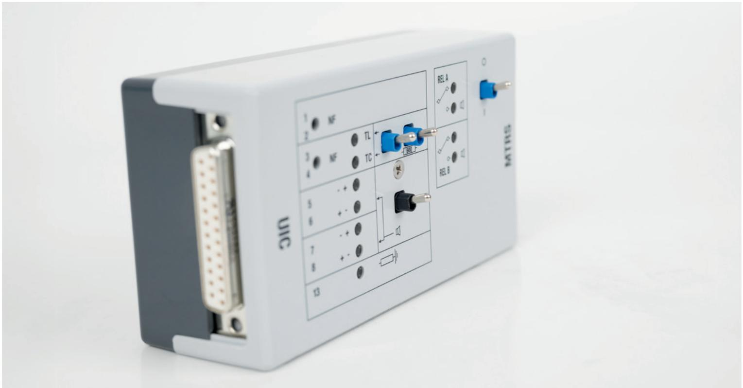
Funkwerk hat den **Testadapter TAU** als Werkzeug zur Wartung, Prüfung und Inbetriebnahme von Zugfunkanlagen entwickelt. Der **Testadapter TAU** ist ein Gerät zum schnellen und einfachen Prüfen des sachgemäßen Anschlusses einer Zugfunkanlage an die Wagendurchgangsleitung nach UIC-Merkblatt 558.
