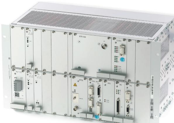
Die MTRS 1+A RSH ist ein für den Betrieb im GSM-R-Netz und analogem Funknetz nach UIC 751-3 (450 MHz) konzipiertes Endgerät für Zugfunk-/Rangierfunk- und Datenfunk-Anwendungen. Es erfüllt die europäischen Anforderungen für den Einsatz auf Schienenfahrzeugen.
