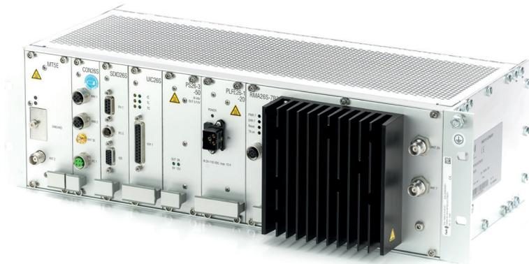
Das Cabradio CR26S ist ein für den Betrieb im GSM-R-Netz und im analogen Funknetz konzipiertes Endgerät für Zugfunk-/Rangierfunk- und Datenfunk-Anwendungen. Es erfüllt die europäischen Anforderungen für den Einsatz in Schienenfahrzeugen.
