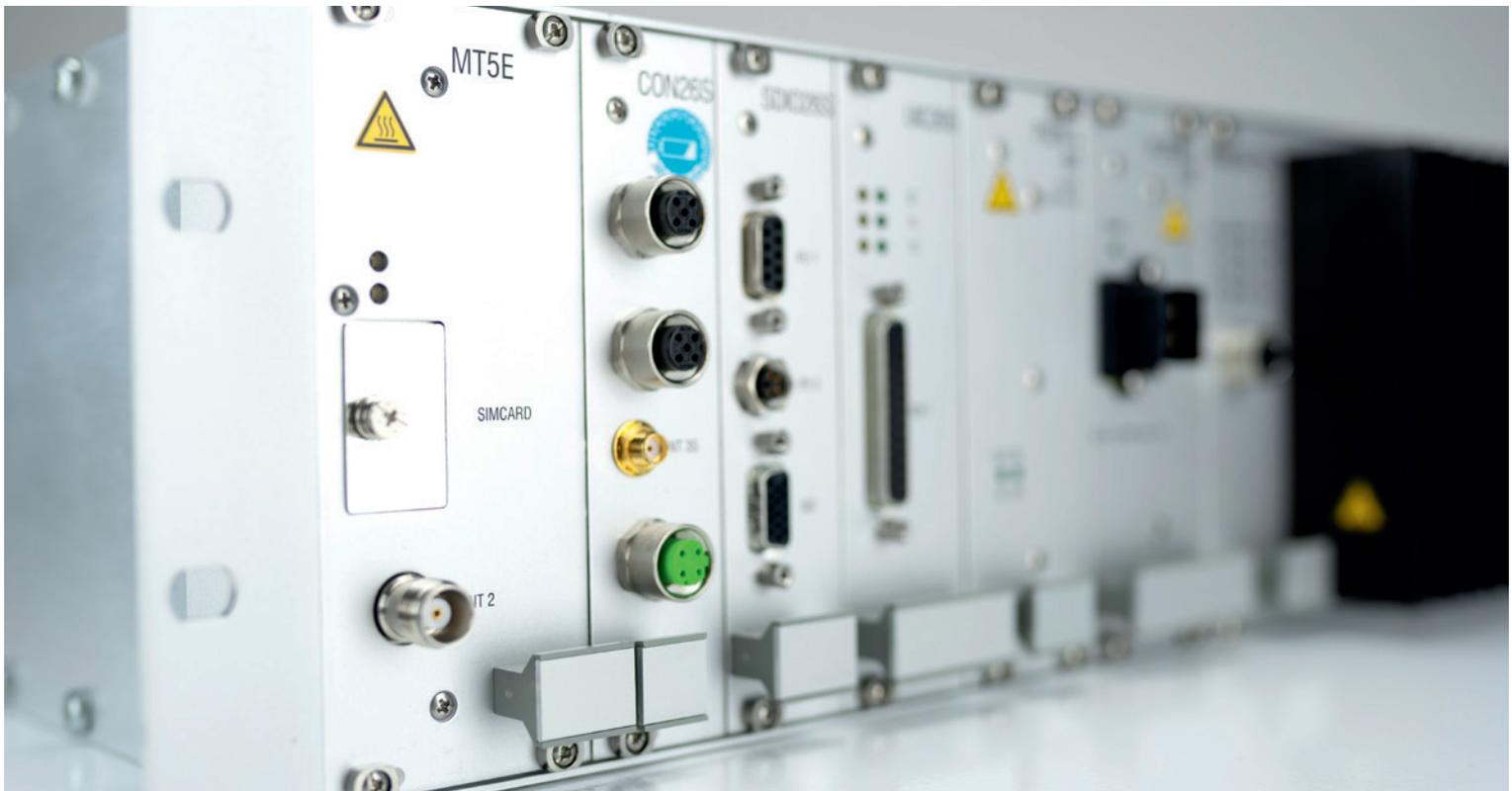
Das Cabradio **CR26S** ist ein für den Betrieb im GSM-R-Netz und im analogen Funknetz konzipiertes Endgerät für Zugfunk-/Rangierfunk- und Datenfunk-Anwendungen. Es erfüllt die europäischen Anforderungen für den Einsatz in Schienenfahrzeugen. Das Gerät ist modular aufgebaut und damit für die jeweiligen Kundenanforderungen entsprechend konfigurierbar.
