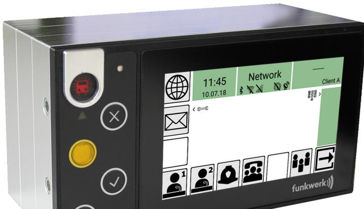
Basierend auf der langjährigen Erfahrung auf dem Gebiet Zugfunk hat Funkwerk ein 5G basiertes Cab Radio entwickelt.
