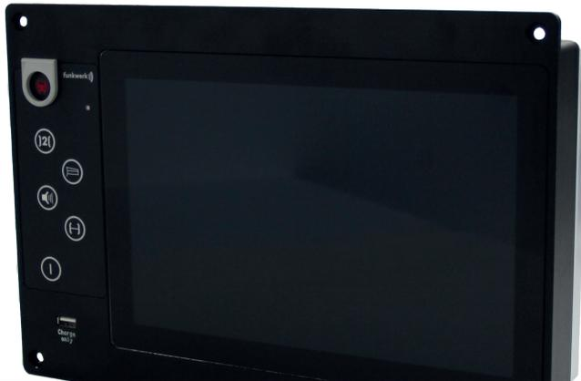
Das Bedienteil MMIL der Zugfunkfamilie MESA 26 ist für die menügeführte Steuerung des digitalen und analogen Zugfunks vorgesehen. Es erfüllt die Anforderung für den Einsatz auf Schienenfahrzeugen und ist für den Pulteinbau im Führerstand konzipiert. Mit Hilfe einer Sprechereinrichtung, bestehend aus Handapparat und Lautsprecher, ist der Triebfahrzeugführer in der Lage, vielfältige Kommunikationsaufgaben durchzuführen.
