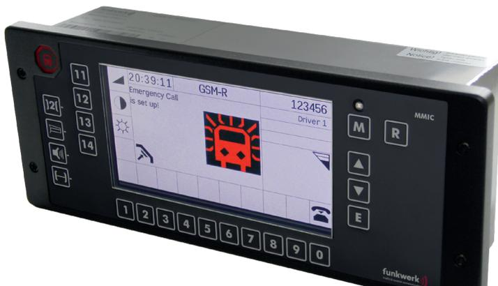
Die Bedienteile MMIC der Zugfunkfamilie MESA 26 sind für die menügeführte Steuerung des digitalen und analogen Zugfunks vorgesehen. Sie erfüllen die Anforderungen für den Einsatz auf Schienenfahrzeugen und sind für den Pulteinbau im Führerstand konzipiert. Mit Hilfe einer Sprechereinrichtung, bestehend aus Handapparat und Lautsprecher, ist der Triebfahrzeugführer in der Lage, vielfältige Kommunikationsaufgaben durchzuführen.
