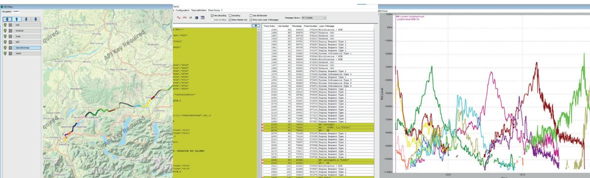
Mit Trace2 können aufgezeichnete Trace-Nachrichten angezeigt und analysiert werden. Die Tracedaten werden auf dem MT-Modul erstellt und über ein proprietäres binäres Trace-Protokoll zwischen MT-Modul und PC an den Trace2-Server übertragen, wo sie dekodiert werden.
