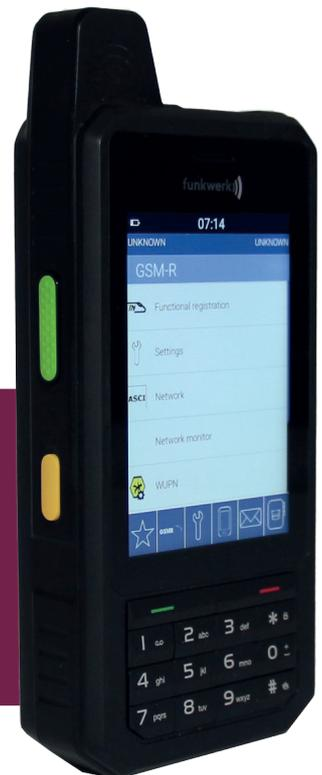
Das Handfunkgerät focX 2 gehört zur neuen Generation unserer Produktpalette focX<sup>®</sup>. Es ist ein GSM-R Endgerät für professionelle mobile Kommunikationsanwendungen.
