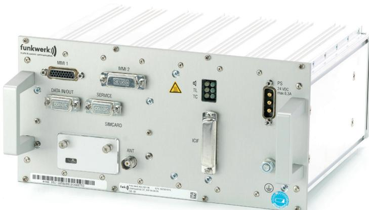
Die MTRS 1 BC ist ein für den Betrieb in GSM-R-Netzen konzipiertes Endgerät für Zugfunk-/Rangierfunk- und Datenfunk-Anwendungen. Es erfüllt die europäischen Anforderungen für den Einsatz in Schienenfahrzeugen.
