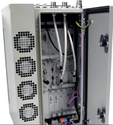
Die MTRS 1+A BSH ist ein für den Betrieb im GSM-R-Netz und analogem Funknetz nach UIC 751-3 (450 MHz) konzipiertes Endgerät für Zugfunk-/Rangierfunk- und Datenfunk-Anwendungen. Es erfüllt die europäischen Anforderungen für den Einsatz auf Schienenfahrzeugen.
