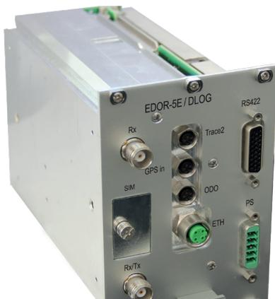
RIU-ETCS - Funkwerk's mobile Lösung für ETCS-Anwendungen besteht in der Standardversion aus völlig unabhängigen Funkeinheiten EDOR-5E mit integriertem state-of-the-art GSM-R-Mobilfunkmodul MT5-E (8 Watt) und der Weitbereichs-Stromversorgung (24 bis 110 V Bordspannung).
